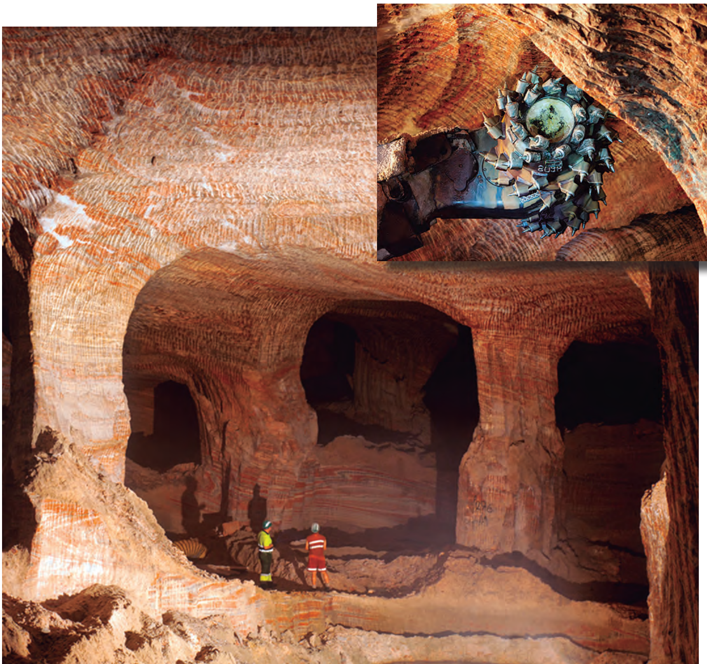
Figura 3. Vista de l'interior de la mina de Vilafruns, a Sallent, a la zona rica en silvita. A la part superior dreta es mostra un detall del capçal de rosa que serveix per arrencar el material. Foto: ICL Iberia
